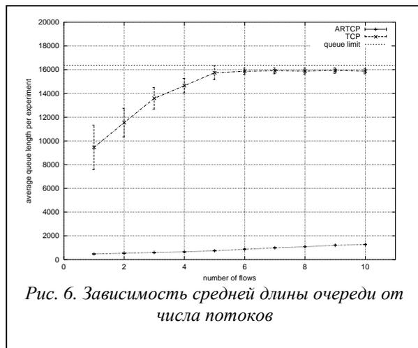
При небольшом числе активных соединений эффективность использования ПС канала для TCP несколько выше. С ростом количества соединений коэффициент использования ARTCP ресурсов канала приближается к единице, в то время как для TCP эффективность использования канала снижается из-за ретрансляций.
