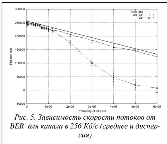
Рис. 5. Зависимость скорости потоков от BER для канала в 256 Кб/с (среднее и дисперсия)
