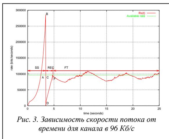
Для пояснения принципов функционирования ARTCP рассмотрим сценарий с **одним потоком ARTCP**, ограниченным каналом с ПС 96 Кб/с и задержкой 0.1 с. Максимальная длина очереди в маршрутизаторе R1 составляет 16 Кбайт. На рис. 3 приведен график зависимости скорости отправки потока от времени. На графике отмечены режимы SS, MD1, REC, FT, через которые проходит алгоритм. Потерь пакетов в данном эксперименте не происходит.
