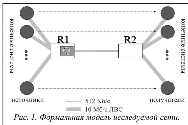
Каждый из узлов в одной из ЛВС отправляет сегменты с межсегментным интервалом  $\tau_s(t) = S/R_s(t)$ , где  $R_s(t)$  задается алгоритмом управления потоком ARTCP. Предполагается, что источники потоков всегда имеют информацию для отправки. Источники и приемники трафика находятся в разных ЛВС. Приемники трафика ARTCP отправляют подтверждения в противоположном направлении в виде сегментов, не содержащих данных.
